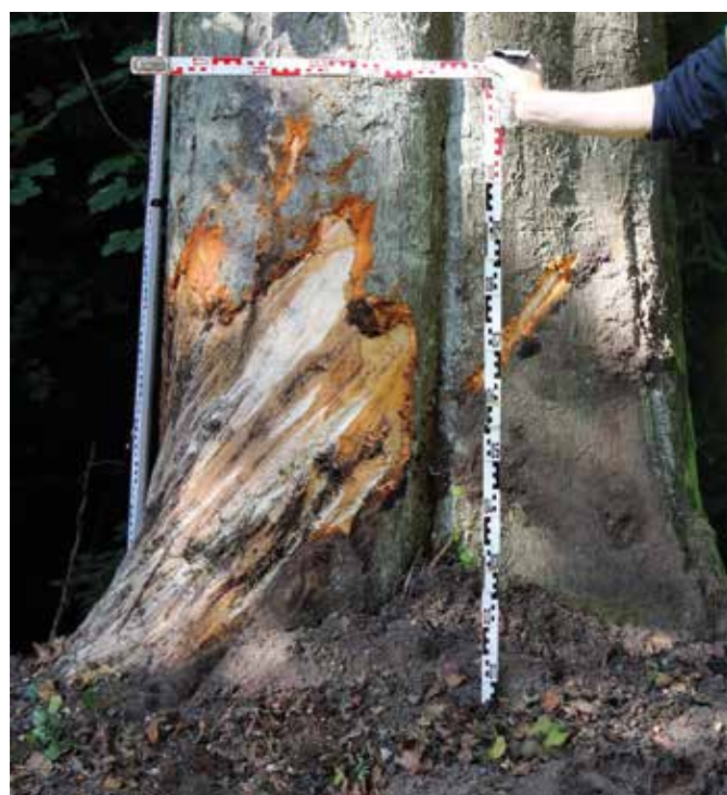
Obr. 3. Stopy po kontaktu s vozidlem č. 1 zanechané na stromě. Fig. 3. Marks left on a tree after contact with vehicle no. 1.
