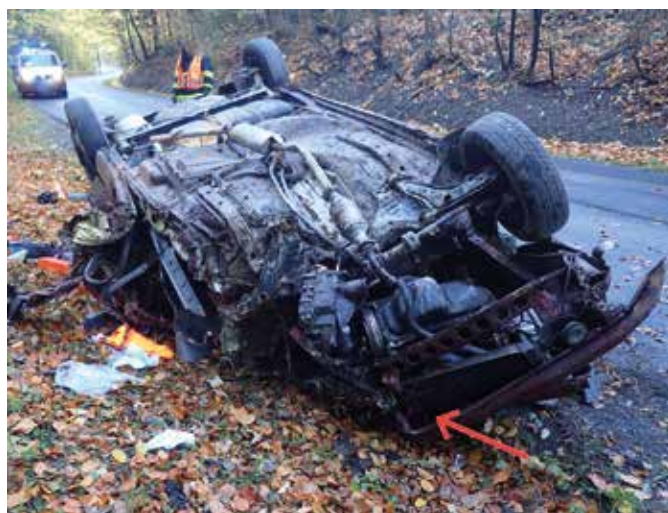
Obr. 8. Ukázka deformace exteriéru vozidla č. 2. Fig. 8. Illustration of the vehicle no. 2 exterior deformation.
