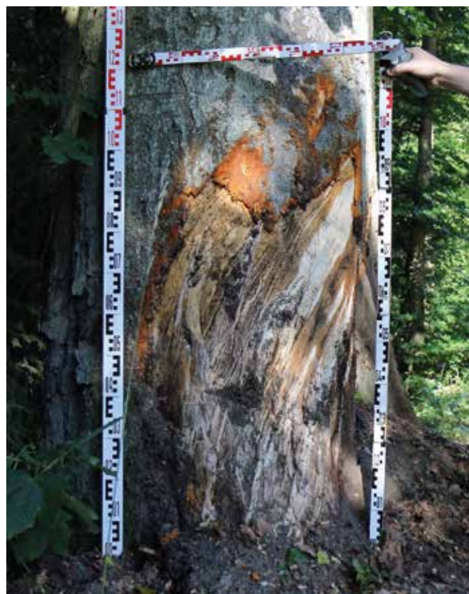
Obr. 2. Stopy po kontaktu s vozidlem č. 1 zanechané na stromě. Fig. 2. Marks left on a tree after contact with vehicle no. 1.
